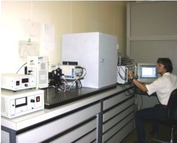
Photoelektrochemischer Meßplatz am PSI In der Schweiz. Alle Komponenten (Chopper, Monochromator Mit Filter und Potentiostat werden mit EcmWin gesteuert.
