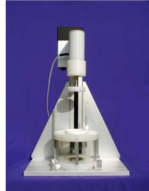
Großer Rotator mit 80mm Scheibe für Erosionsuntersuchungen
